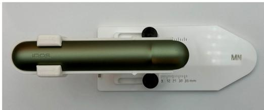
*El soporte MN tiene dos reglas paralelas. Cada marca está separada 3 mm. Ajuste el soporte aflojando sólo un poco los dos tornillos negros y deslizando el soporte hasta la marca correspondiente. Elija la marca más próxima a la anchura del texto indicada en W.*
