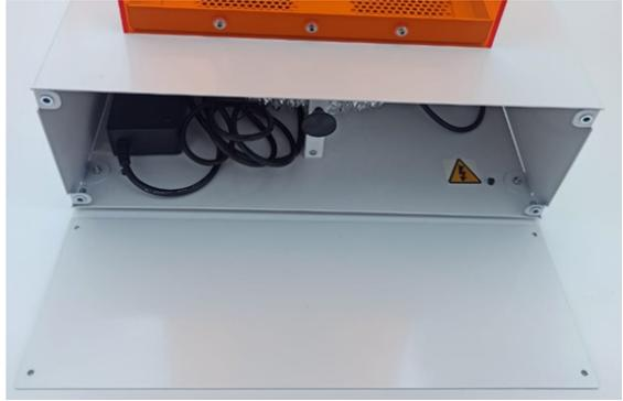
2. Una vez retirada la cubierta posterior de la estación de grabado láser, retire la cubierta de la caja del filtro.
